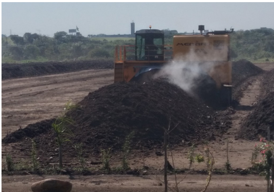
Figura 3. Máquina revolvendo uma pilha sendo compostada na Usina Verde de Compostagem de Campinas. Foto: Berton, R. S.
