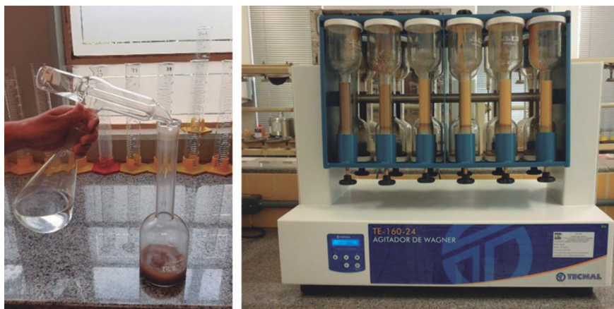
Figura 4. Dosagem do dispersante e agitador de amostras com garrafas de Stohmann.
