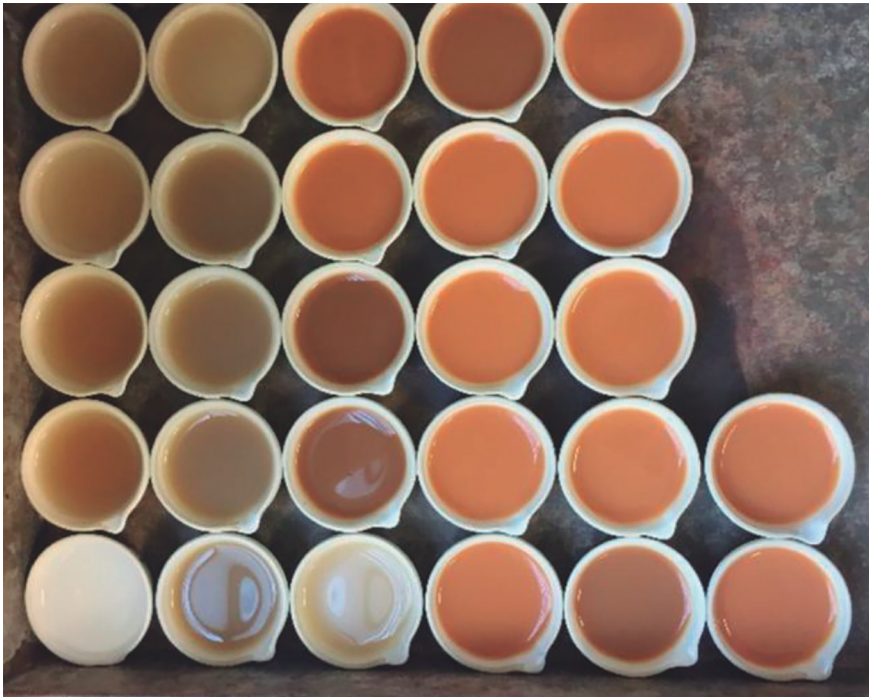
Figura 8. Cápsulas de porcelana preparadas para a secagem em estufa, contendo as alíquotas das frações argila + silte e argila e da prova em branco (apenas com a solução dispersante).
