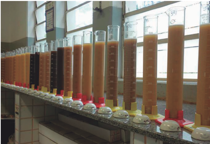
Figura 7. Suspensão com frações silte e argila aguardando o tempo de sedimentação.
