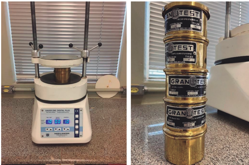
Figura 6. Agitador para separação das frações de areia e conjunto de peneiras para separação em cinco frações.
