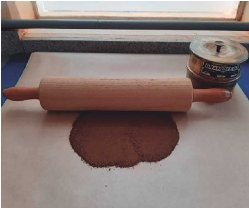
Figura 2. Preparo da amostra para análise granulométrica: apoio de borracha, rolo de madeira e peneira 2 mm com tampa para agitar a amostra.
