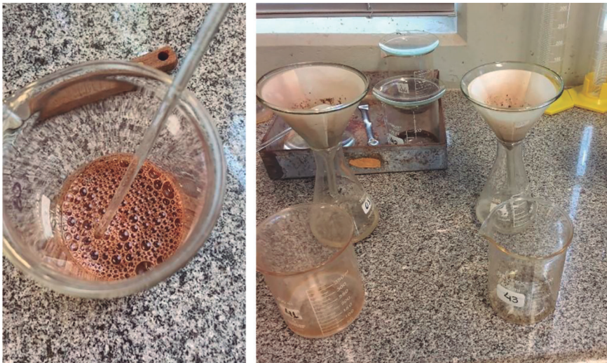
Figura 3. Adição de água oxigenada ( H_2O_2 ) e lavagem da amostra de solo.
