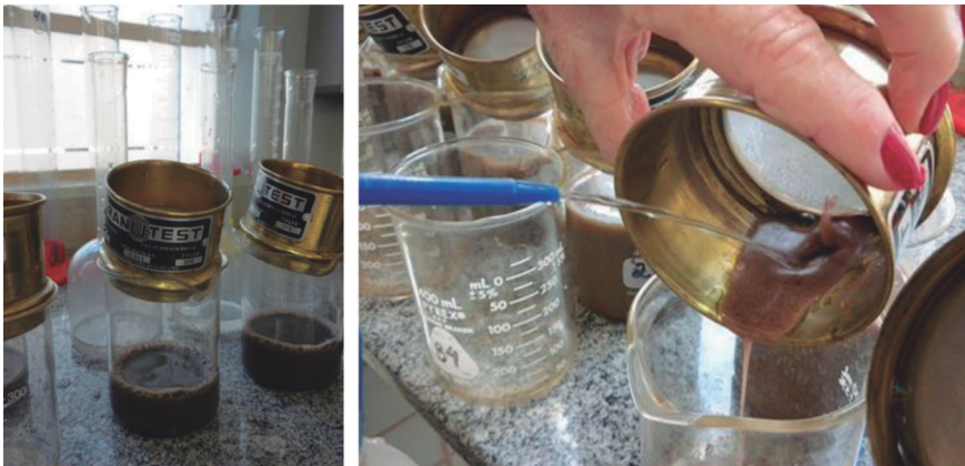
Figura 5. Separação da fração areia utilizando a peneira de abertura de malha 0,053 mm.
