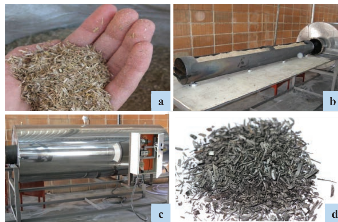
Figura 1. (a) Biomassa do biocarvão (palha de cana-de-açúcar); (b) Biomassa no reator; (c) Vista do reator; (d) Biocarvão pronto.
