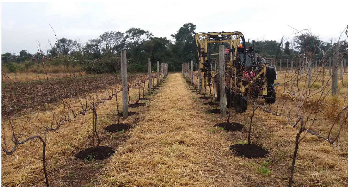
Figura 1. Execução da pré-poda para eliminação dos ramos, com podador desenvolvido no Centro Avançado de P&D de Engenharia Agrícola-IAC.
