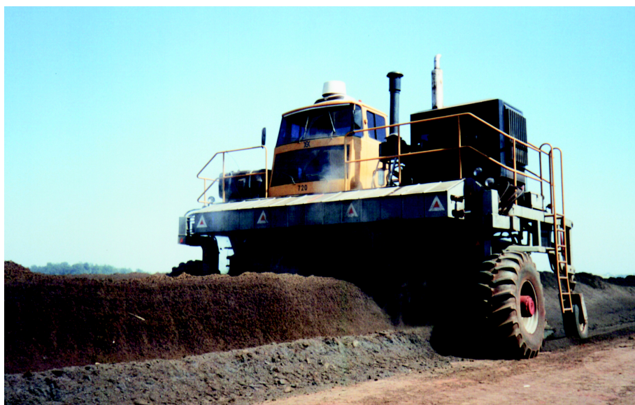
Figura 7. Compostagem de torta de filtro de cana-de-açúcar através de equipamento do Centro de Tecnologia Canavieira (ex-Copersucar). Piracicaba. (Gentileza: Célio Manechini).
