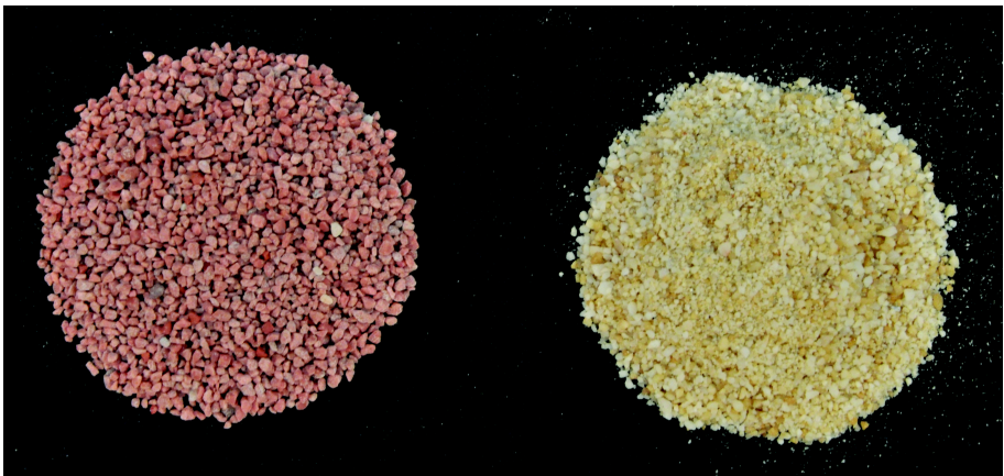
Figura 6. KCl vermelho e KCl amarelo com os mesmos teores de K_2O . (Foto: André Luis Trani).
