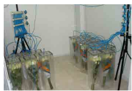
Figura 12. Fluxocentro para simulação de atmosfera controlada para flores.
